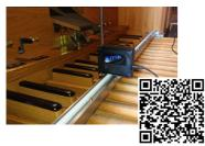
Ideal für alle, die für die Manualklaviaturen einen sep. Tastendrücker wie den Magnetaufsatz (Holzapfel) haben und in Zukunft auch beim Stimmen und auch bei einfachen Intonationsarbeiten im Pedal diesen Helfer einsetzen wollen.
