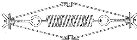
Durch die Umleitung der Spiralfederkraft wird im geometrischen System bei der Plattenbewegung der nachlassende Druck der Spiralfeder ausgeglichen und damit ein gleichbleibender Druck auf die Balgplatte erzielt. Bei flachem Einbau kann sogar eine zusätzliche Drucksteigerung erreicht werden und damit bei hohem Windverbrauch der Winddruck gesteigert werden.
